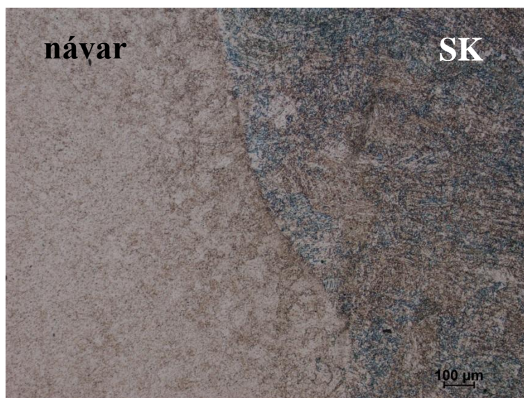
Obr. 6.60 – Mikrostruktura rozhraní návar – SK
