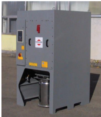
Obr. 34 Filtrační jednotka Keller řady L-Cut [37]
