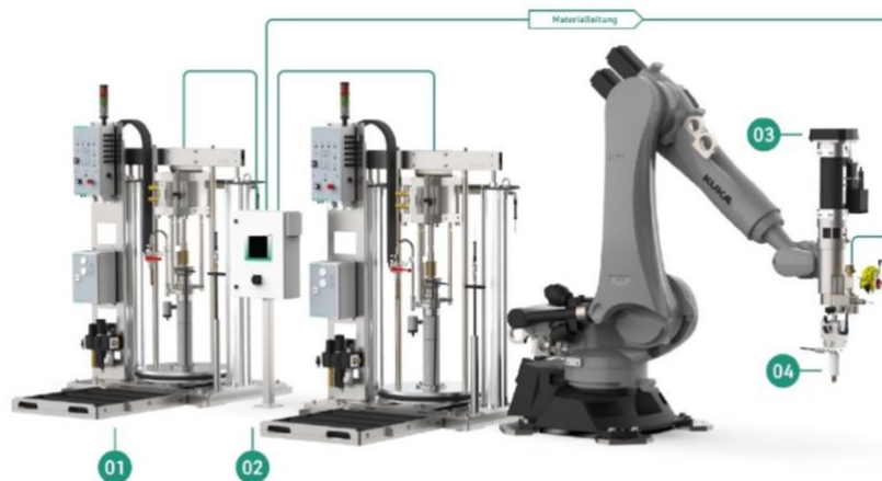
Obr. 19 Technologická hlavice pro lepení jako nástroj na robotu [26]
