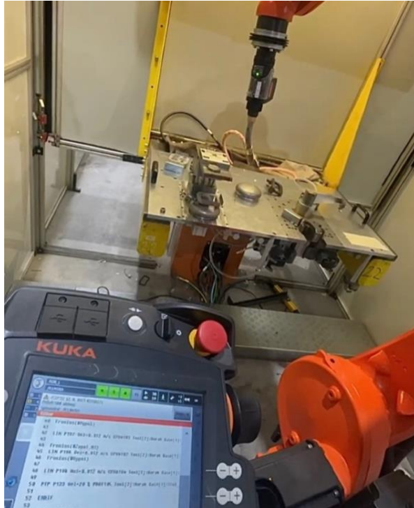
Obr. 11 Ukázka online programování svařovacího robota
