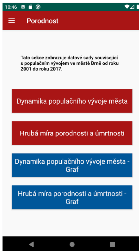
Obr. 3.2: Ukázka vzorového fragmentu s komponenty TextView a Button
