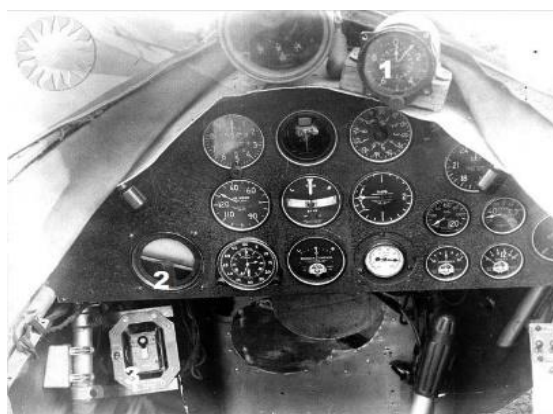
Obrázek 1: Kokpit s panelem přístrojů letounu NY-2 Husky [27]
