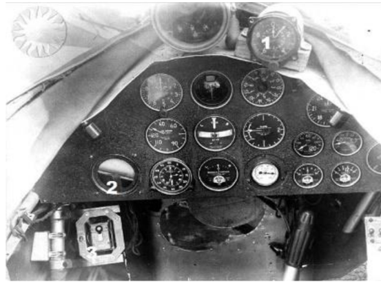
Obrázek 1: Kokpit s panelem přístrojů letounu NY-2 Husky [27]
