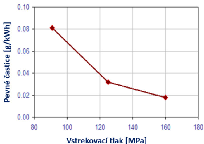
Obr. 61 Vplyv vstrekovacieho tlaku na tvorbu pevných částic [21]
