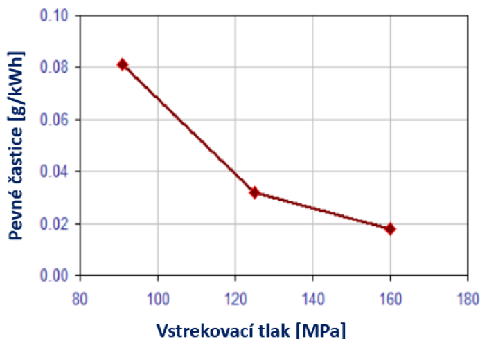
Obr. 61 Vplyv vstrekovacieho tlaku na tvorbu pevných častíc [21]
