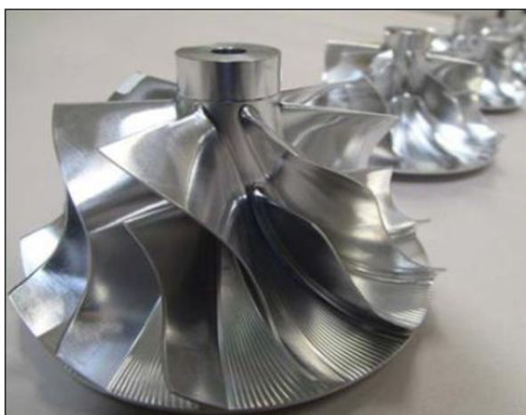
Obr. 14 Kompresorové koleso s polovičnými medzilopatkami „splitter blades“ [4]
