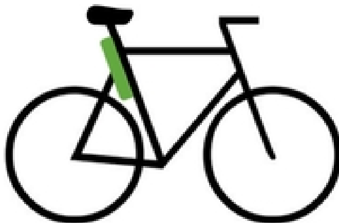
Obr. 11 Umístění baterie za sedlovou rámovou trubku převzato a upraveno z (14)
