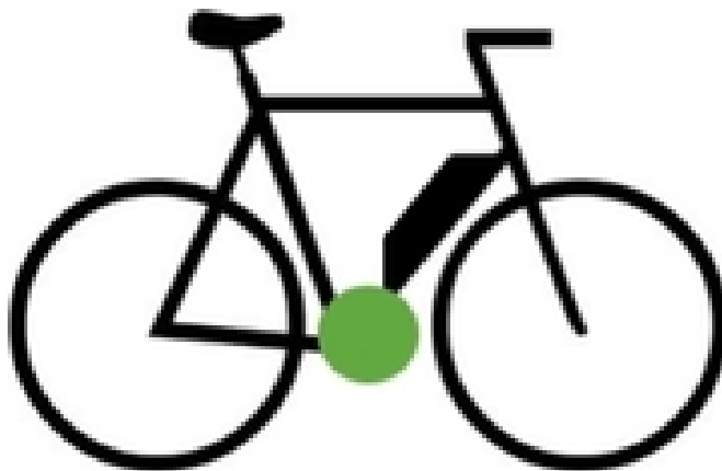
Obr. 5 Umístění středového pohonu převzato a upraveno z (14)
