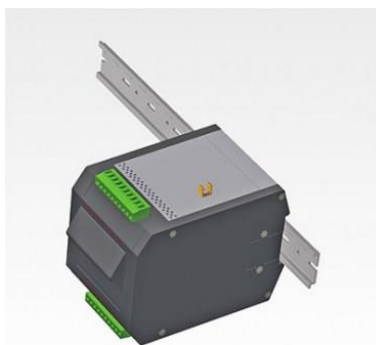
Obr. 20 – Komunikační zařízení K1 (22)
