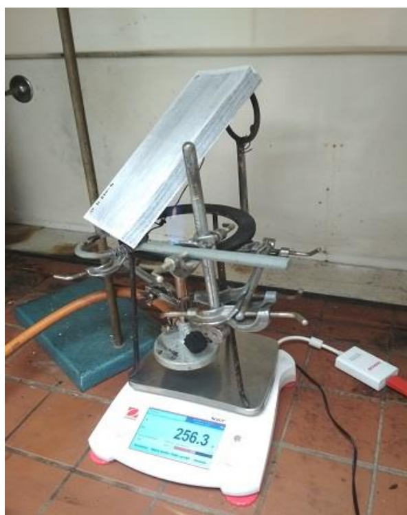
Obr. č. 12 Měření úbytku hmotnosti termicky modifikovaného vzorku s protipožárním nátěrem
