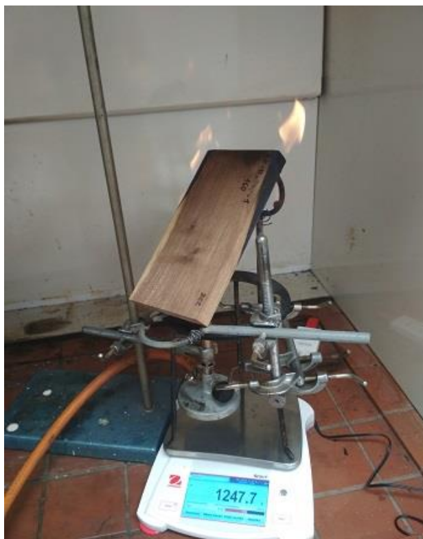
Obr. č. 11 Měření úbytku hmotnosti termicky modifikovaného vzorku bez syntetické ochrany
