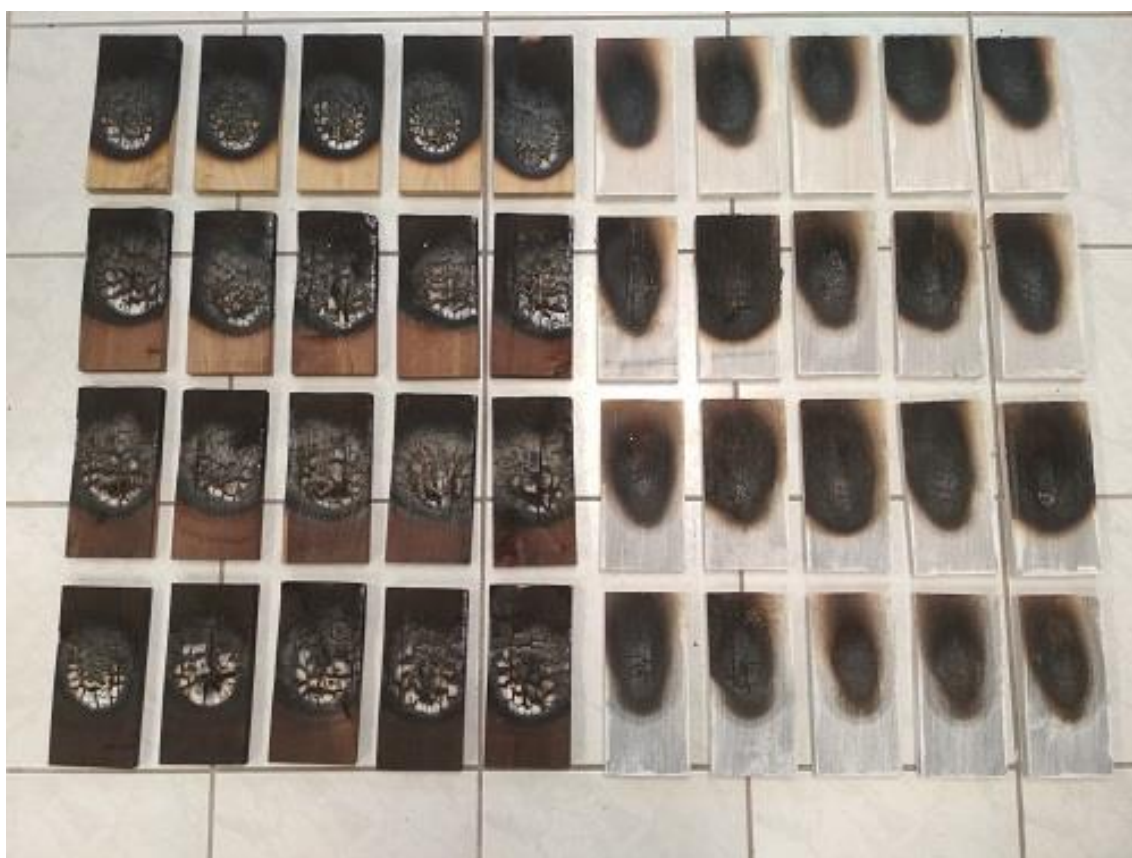
Obr. č. 16 Vizuální porovnání termické degradace mezi skupinami vzorků
