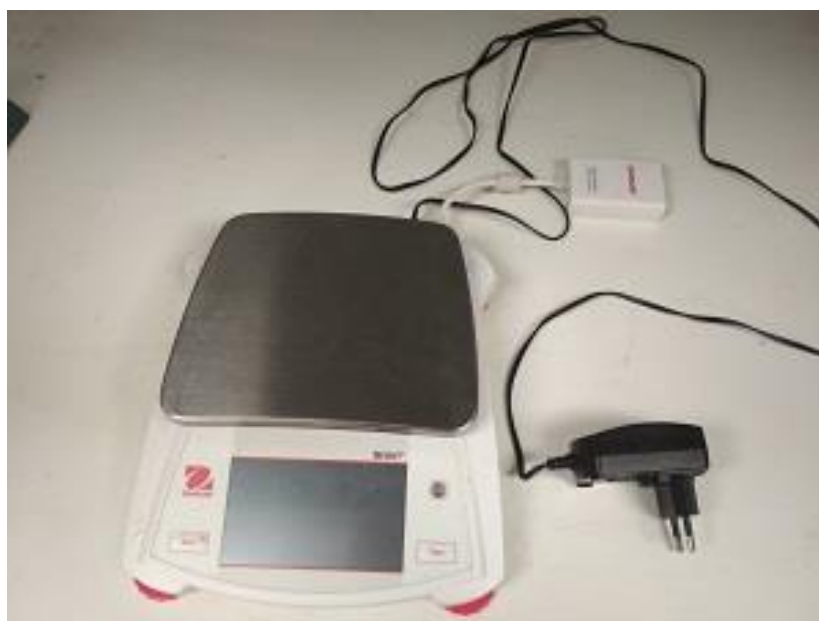
Obr. č. 13 OHAUS typ Scout, model STX2201 s rozhraním USB
