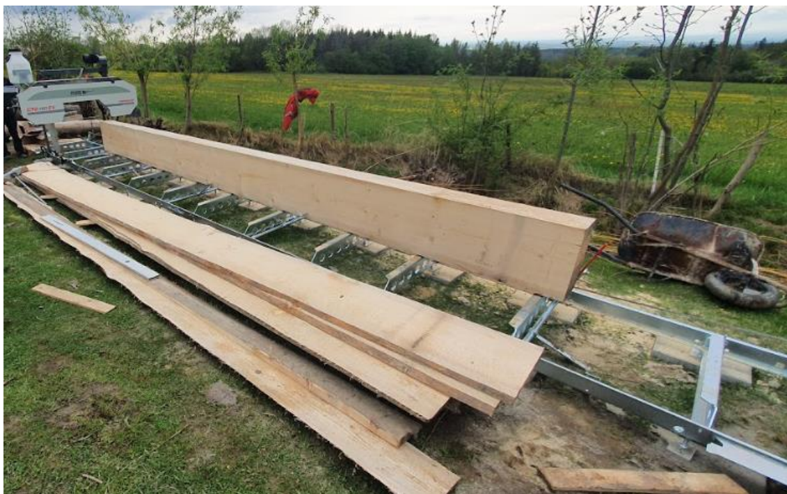
Obrázek 22: Zpracování vytěžené kulatiny na pásové pile Pilous CTR 750 EV, rok 2021.
