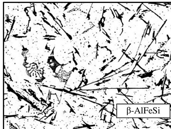
Obr. 2.5 Jehlicová fáze Al_5FeSi [3]
