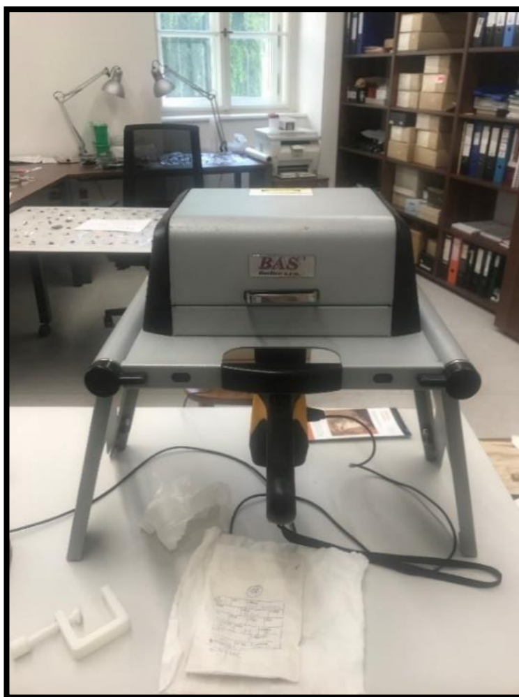
Obr. 15: Ruční ED p-XRF spektrometr Olympus Delta Professional v ochranné kabině. Foto: Zuzana Palová.
