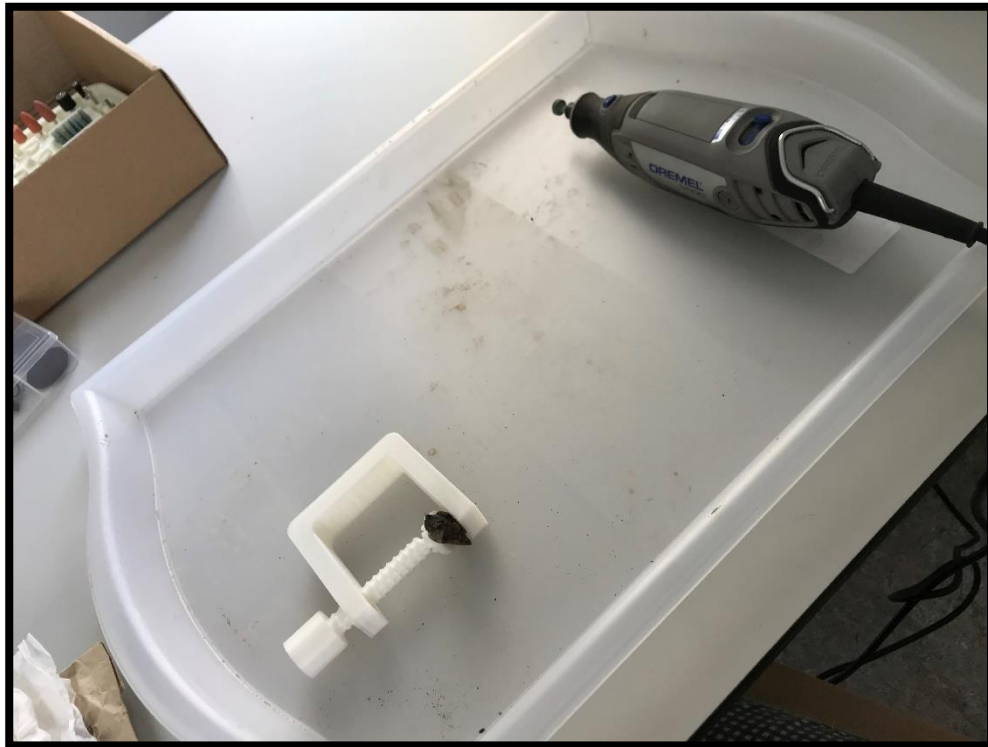
Obr. 16: Tvorba nábrusu na jednom z menších keramických fragmentů nádoby. Foto: Zuzana Palová.
