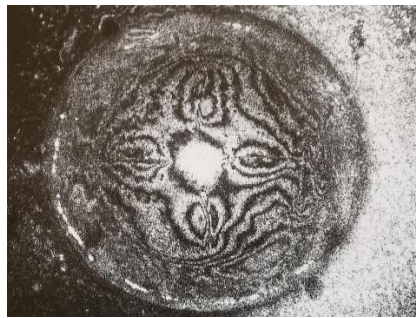
Obr. č. 23 Holografický interferogram rohovky so štyrmi hlbokými radiálnymi rezmi [9]
