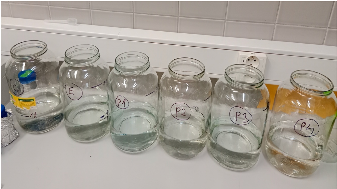
Obr. č. 9: Příprava testovacích roztoků před výměnou lázně.
