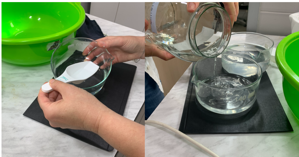
Obr. č. 10 a 11: Výměna testovací lázně.
