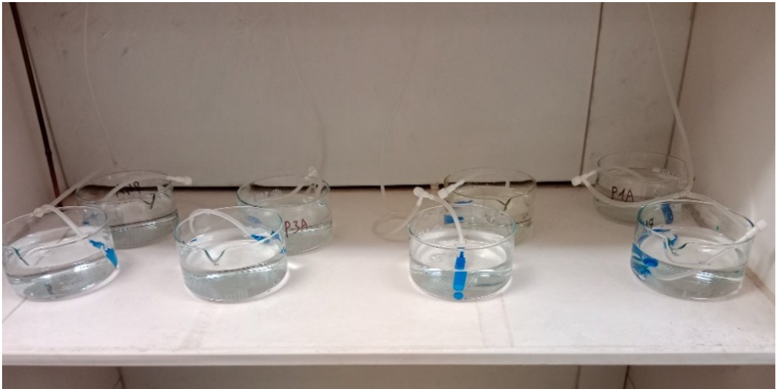
Obr. č. 8: Uspořádání misek během embryolarválního testu toxicity.
