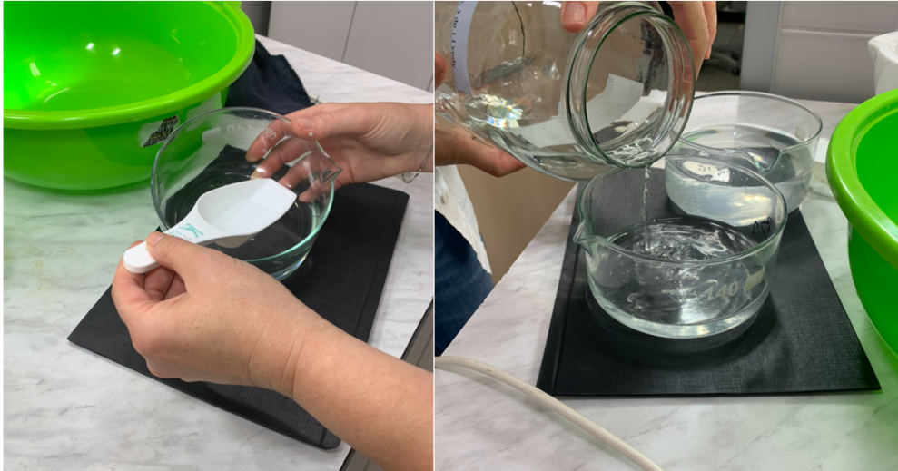
Obr. č. 10 a 11: Výměna testovací lázně.
