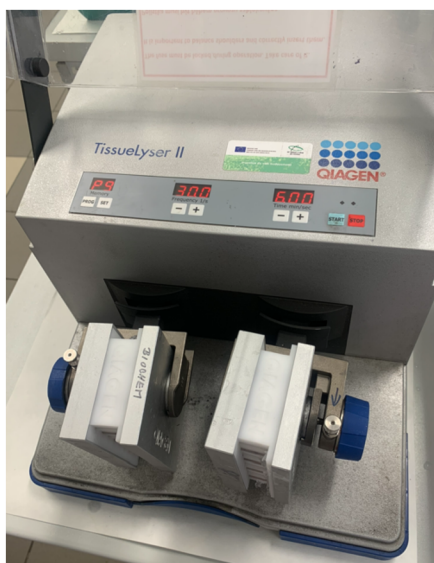
Obr. č. 20: Homogenizace vzorků pomocí homogenizátoru TissueLyser II QIAGEN®.
