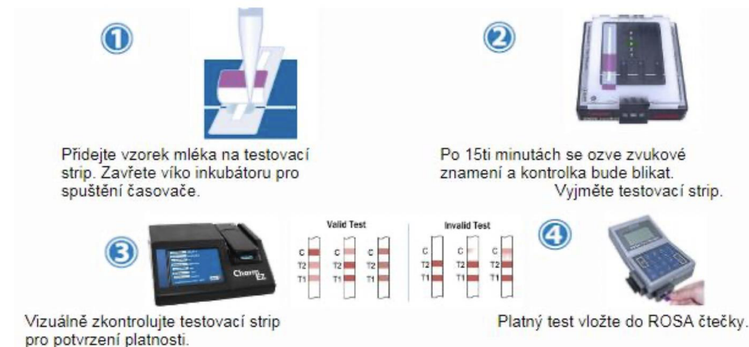
Obrázek 3.1: Postup provedení Charm testů na stanovení aflatoxinu M1 (AFM1) (Zdroj: O. K. SERVIS BioPro, 2022)
