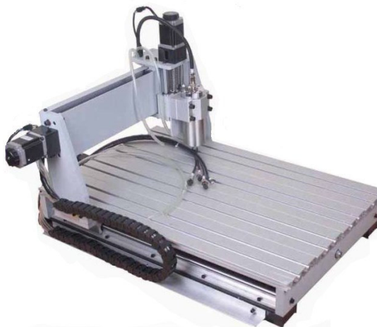
Obr. 25. Modelářská CNC frézka s řízením otáček vřetene pomocí vysokofrekvenčního měniče [3].
