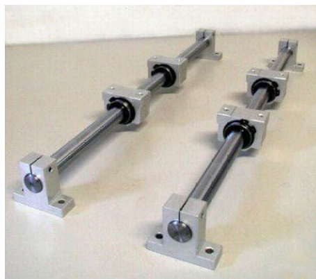
Obr. 9. Vodící tyč podepřená na obou koncích v kombinaci s uzavřeným kuličkovým pouzdem usazeném v domku [3].
