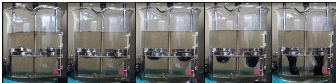
Obrázek 32: Postupné měknutí během metody kroužek-kulička. [23]
