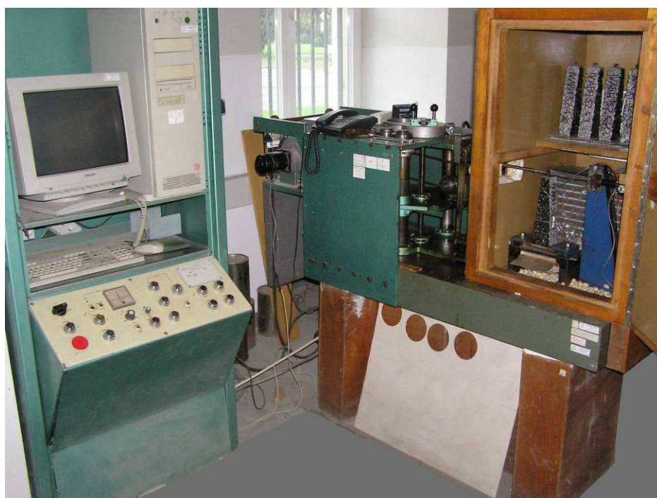
Obrázek 29: Celkový pohled na zařízení pro měření modulů tuhosti asfaltových směsí. [7]
