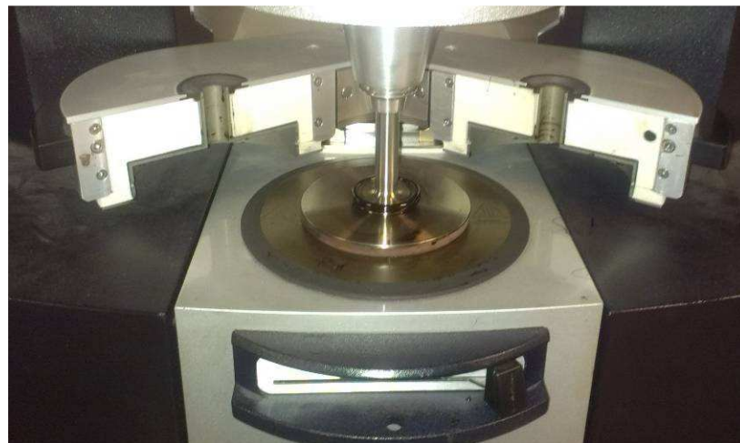
Obrázek 42: Měření oscilace, průměr geometrie 25mm, vzorek před seříznutím.
