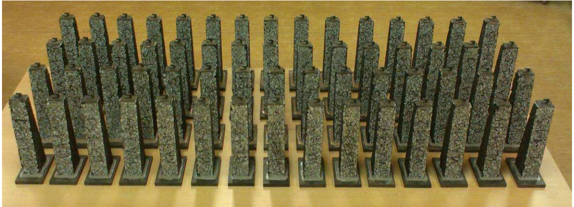
Obrázek 21: Nařezaná zkušební tělesa.
