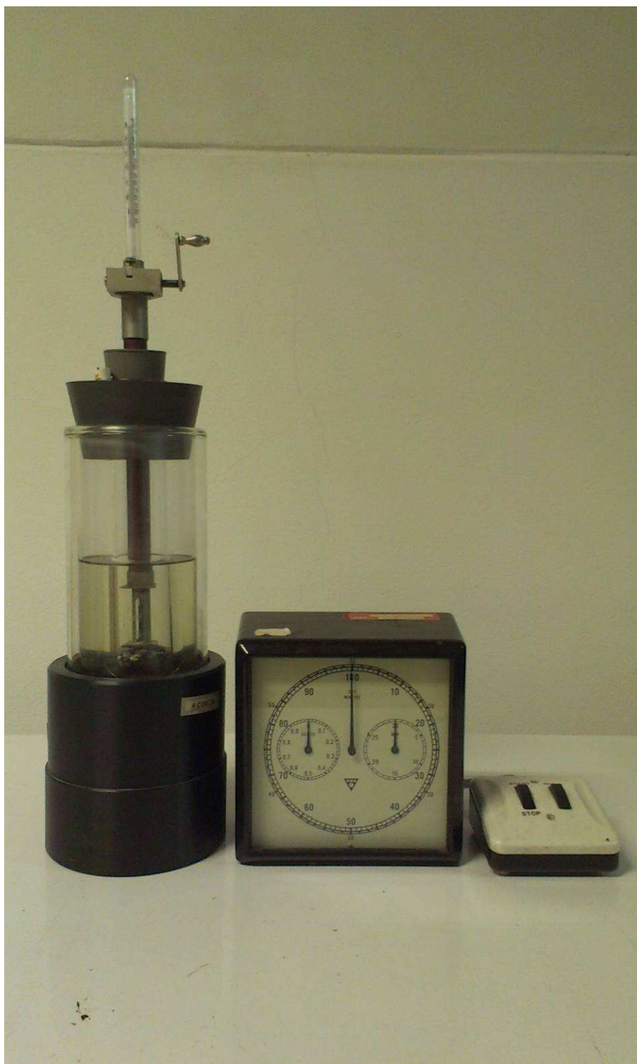
Obrázek 34: Příklad pro měření bodu lámavosti podle Fraaseho.
