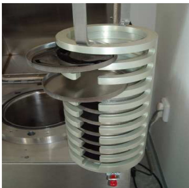
Obrázek 4:Vzorky umístěné do přístroje PAV. [14]
