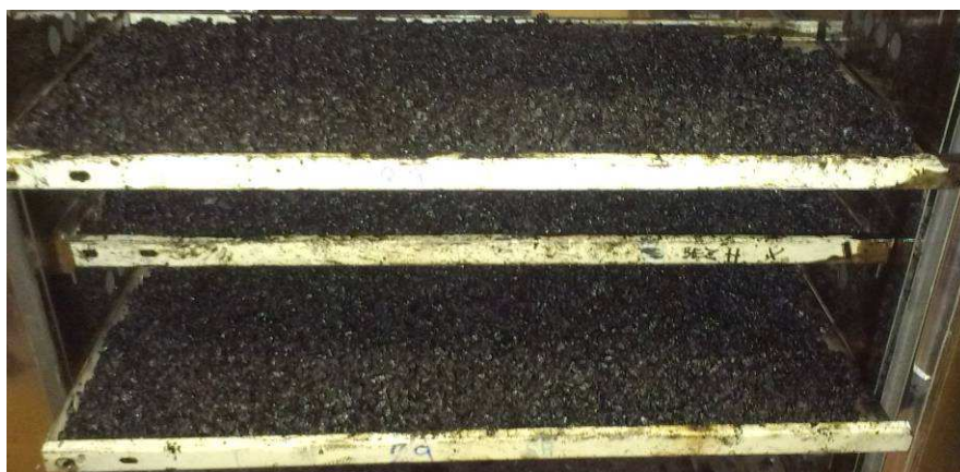
Obrázek 13: Tenká vrstva rozmělněné asfaltové směsi.
