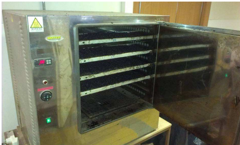
Obrázek 12: Nezhutněná asfaltová směs v laboratorní sušárně s nucenou cirkulací vzduchu.
