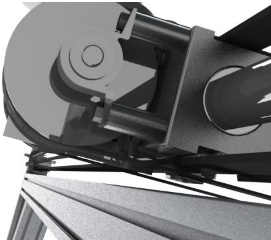
Obr. 5.23 Křížení řemenů v prostoru T1.
