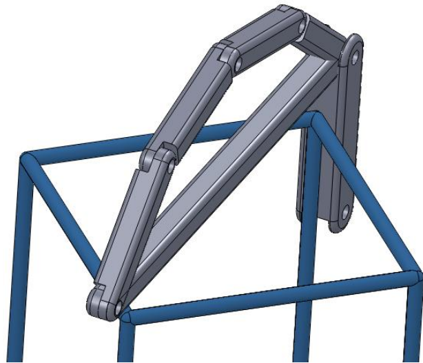
Obr. 4.4 Neuspokojivé varianty ramene při umístění manipulátoru v rohu boxu.
