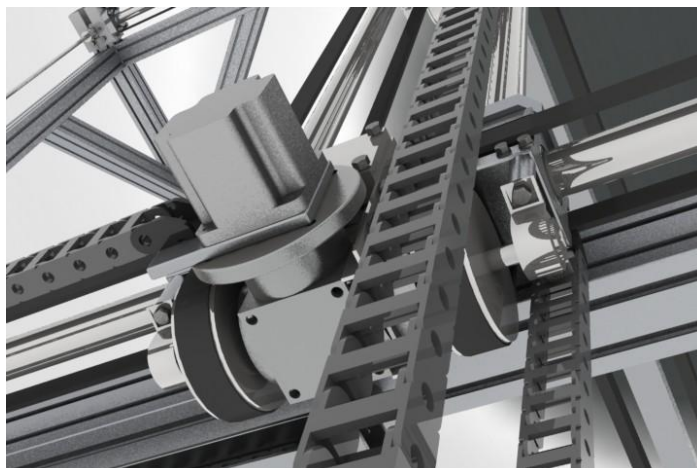
Obr. 35 Energetické řetězy C1 a C2
