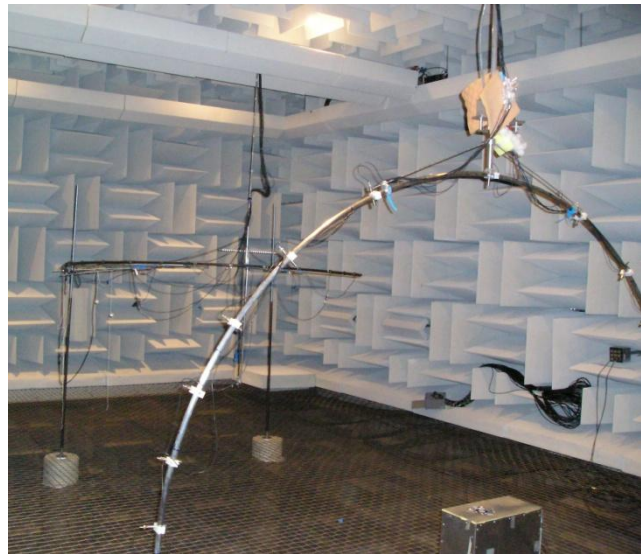
Obr. 4.1 Polohovací systém ve zvukotěsné komoře. [5]
