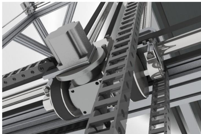
Obr. 35 Energetické řetězy C1 a C2
