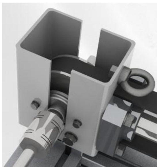
Obr. 5.17 Uložení soustavy H na rámu F.
