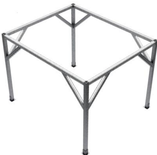
Obr. 5.8 Model rámové konstrukce.
