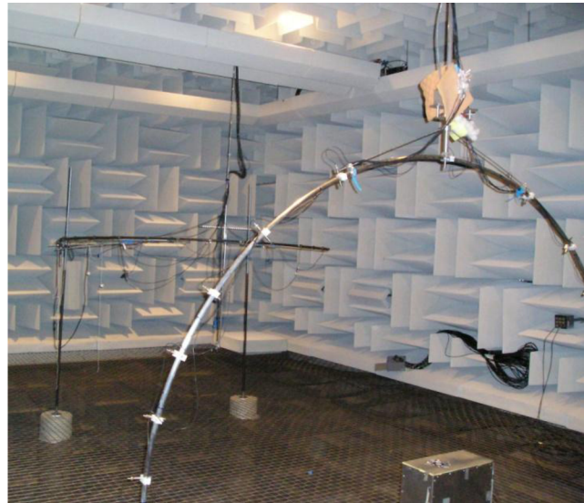
Obr. 4.1 Polohovací systém ve zvukotěsné komoře. [5]
