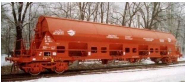
Obr. 2.16 Železniční vůz Tadgs
