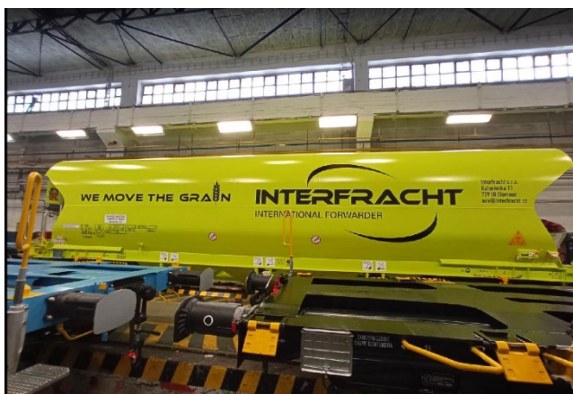
Obr. 2.28 Výroba železničního vozu Tagnpps 110 m 3
