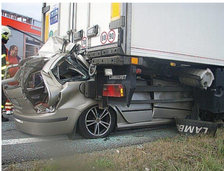
Obrázek 9: Selhání zábran proti podjetí návěsu
