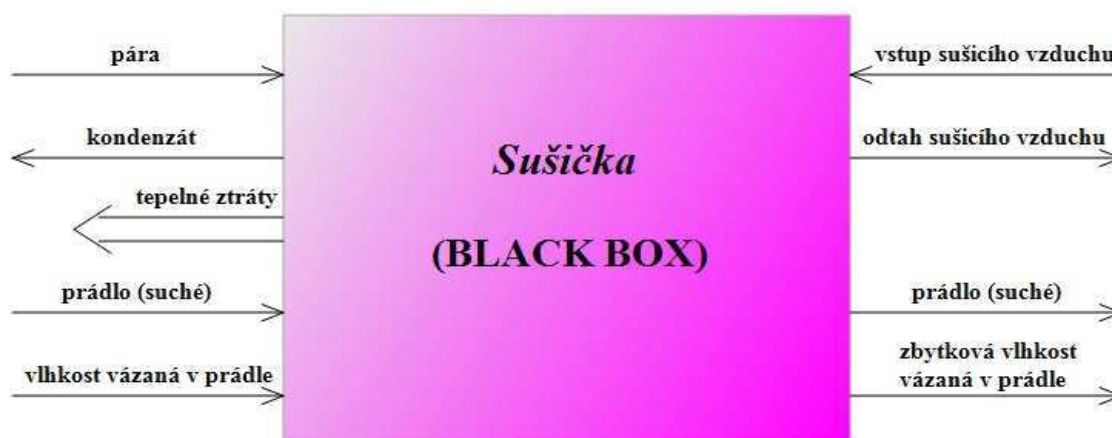
Obr. 5.1 – schéma sušičky jako „Black Boxu“
