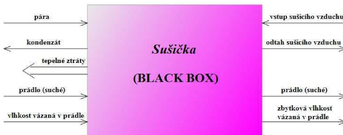
Obr. 5.1 – schéma sušičky jako „Black Boxu“
