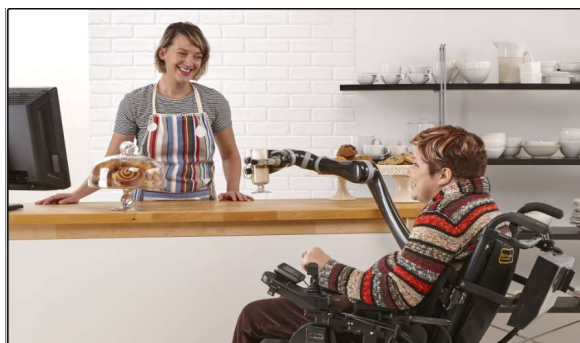
Obr. 12 Robotická paže Roboty Gen 2, která se připevňuje na invalidní vozík
