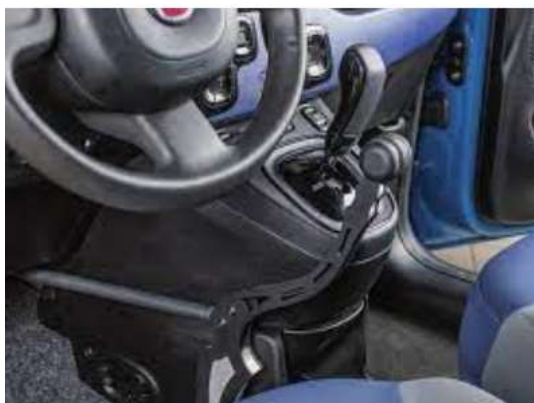
Obr. 16 Ovládání plynu a brzdy jednou pákou.
