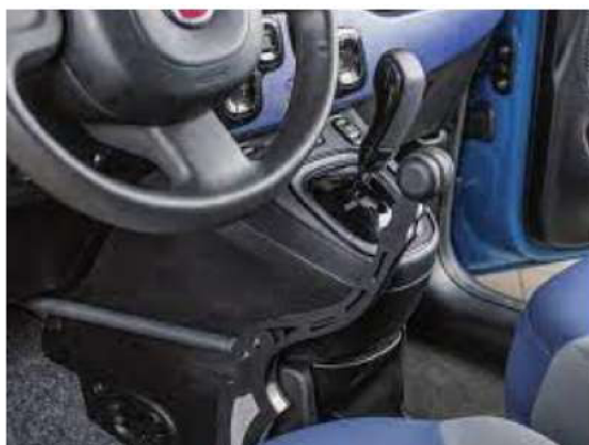
Obr. 16 Ovládání plynu a brzdy jednou pákou.
