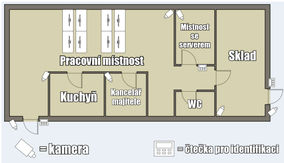
Obrázek 8 Schématický náčrt umístění kamer a přístupového systému
