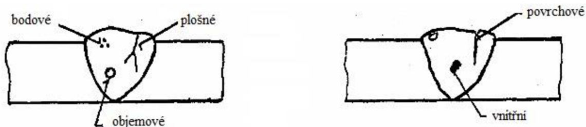
Obr. 18 Vady ve svarech dle tvaru a polohy [38].
