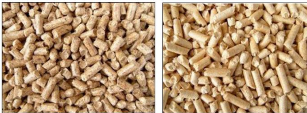
Obr. 14 Dřevní pelety – vlevo s kůrou, vpravo bez kůry [32]
