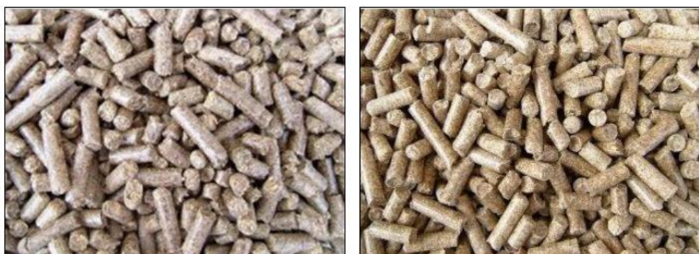
Obr. 15 Pelety ze stébelnin – vlevo ze šfovíku, vpravo z řepky [32]
