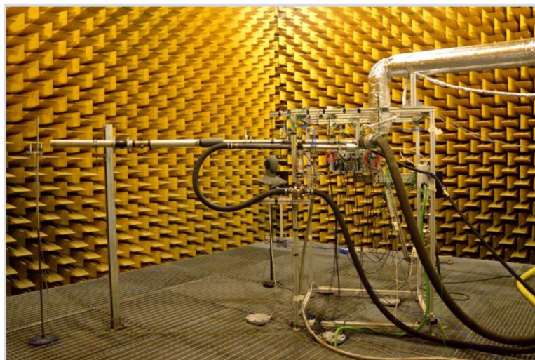
Obr. 3.36 Měřicí prostor s TBD Garrett GT 17, převzato z Tiskar [30]
