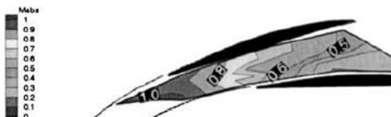
Obr. 2.15 Rozložení Machových čísel v LD, převzato z Krain [13]
