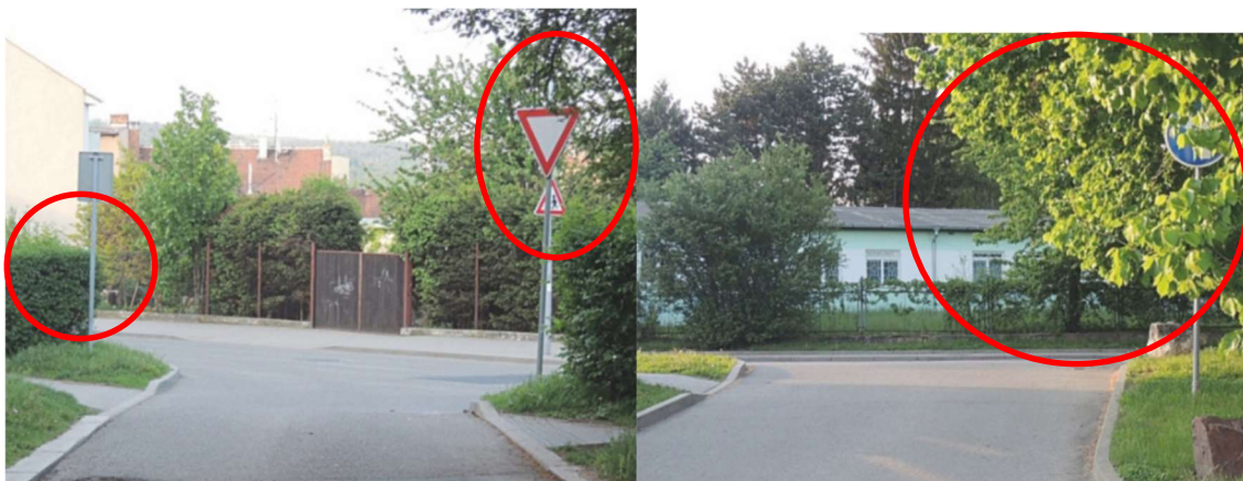
Obrázek 12 Nedostatečný rozhled v křižovatce a zakryté dopravní značení 55
