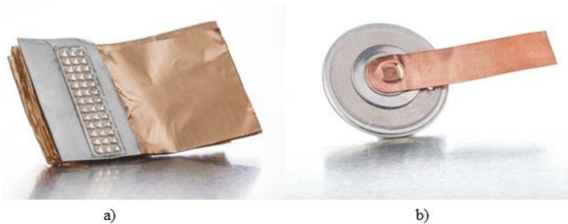
Obrázok 3.6 Ultrazvukové zváranie a) niekoľkých medených fólií dokopy [29] a b) medeného kontaktu na vrchný kontakt cylindrického článku [30]
