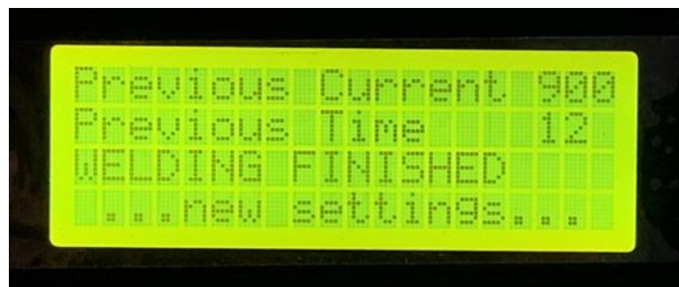
Obrázok 6.2 Nastavenie pracovného prúdu na 900 A, pri dobe zvárania 12 cyklov, čiže 120 ms
