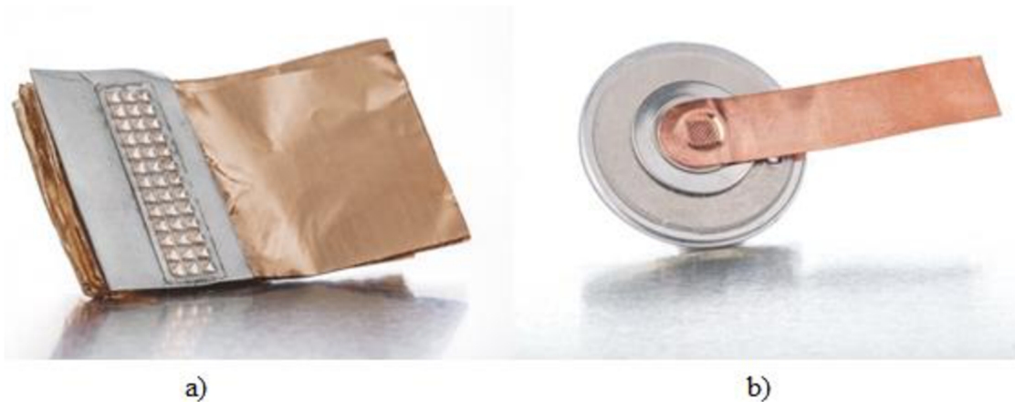
Obrázok 3.6 Ultrazvukové zváranie a) niekoľkých medených fólií dokopy [29] a b) medeného kontaktu na vrchný kontakt cylindrického článku [30]
