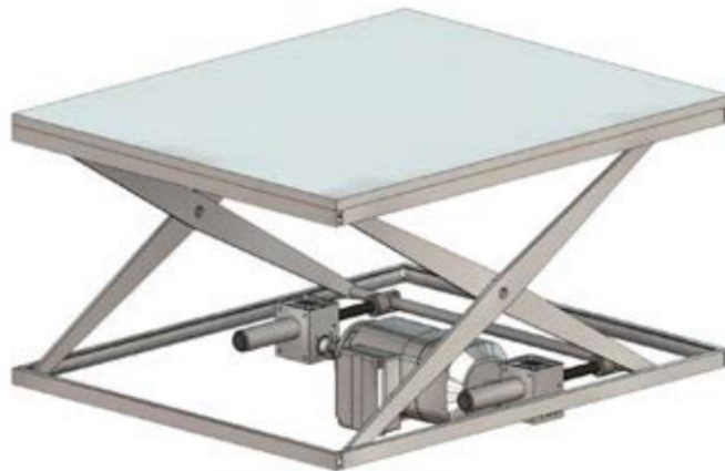
Obr. 7 Zdvih zvedací plošiny pomocí pohybového šroubu [30]
