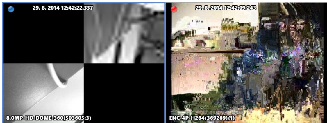
Obrázek 44 - Příklady ztráty přenesených dat obrazu kodek Jpeg200 a H.264 [39]
