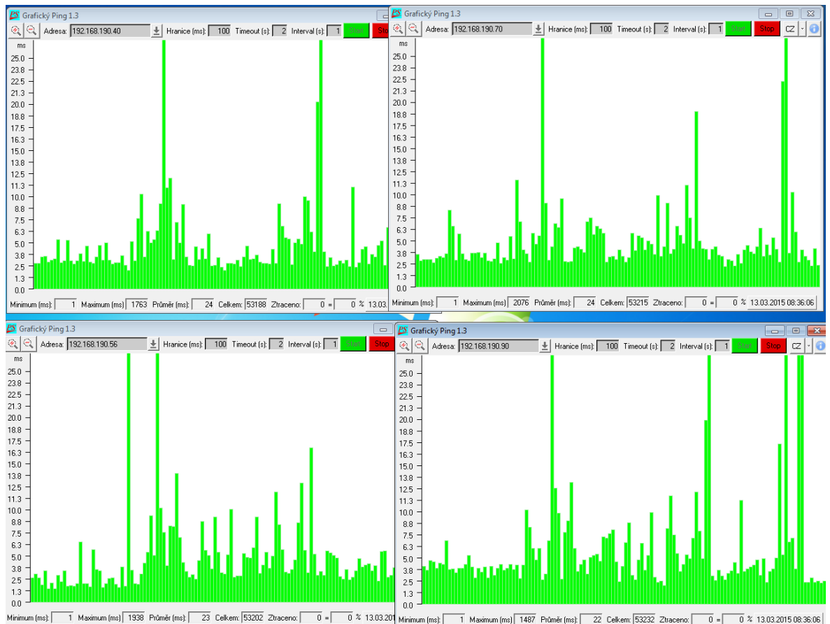
Obrázek 31 - Software GRPING měření vytížení sítě LAN cctv kamery a software OPTIMAX [38]
