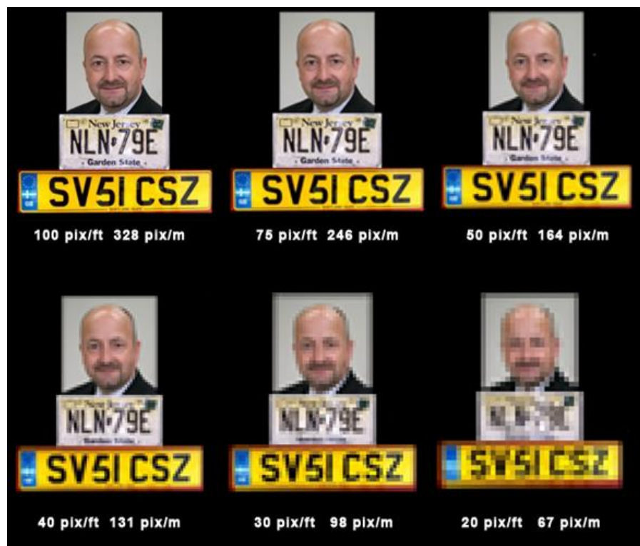
Obrázek 1 - Porovnání rozlišovací schopnosti kamer [1]
