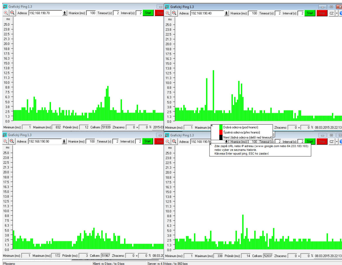
Obrázek 29 - software GRPING měření LAN pouze cctv kamery [38]
