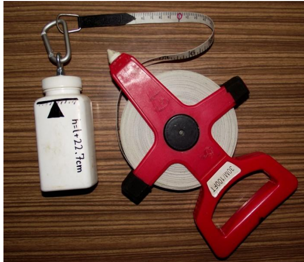
Obr. 13 Úprava pásma k zjištění hloubky vody ve studních
