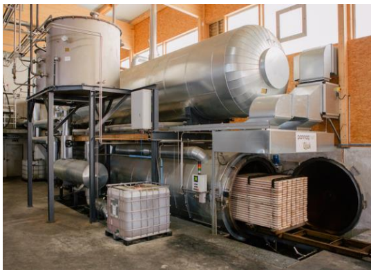
Obrázek 9 - (Zleva) Impregnační nádoby procesu OHT a ukázka použití OHT dřeva (Qijuk.com)
