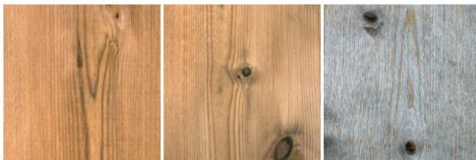
Obrázek 8 - (Zleva) Dřevo smrku neupravené, upravené Plato ® procesem, časem zešednutí povrchu upraveného dřeva (PlatoWood.com)
