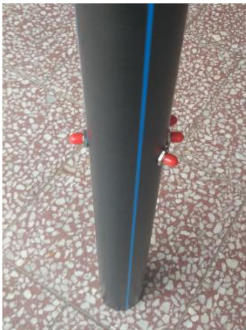
Obr. 9.7: Průtokový přípravek pro měření zakalení
