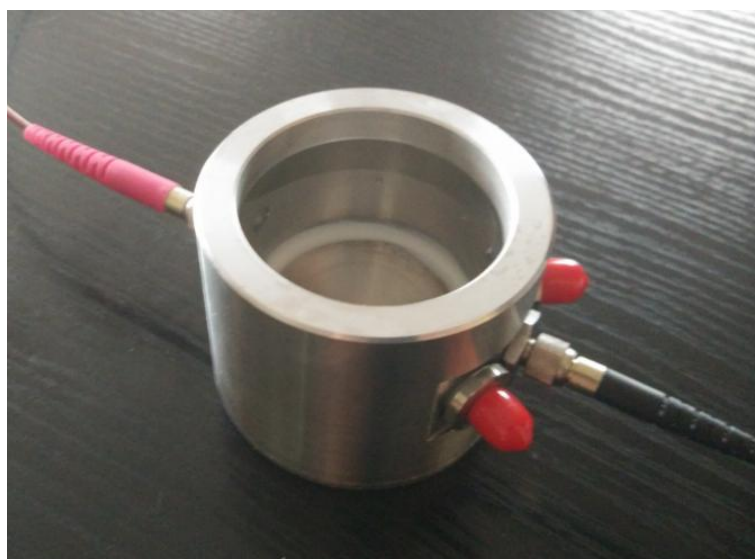
Obr. 8.4: Laboratorní přípravek pro měření zakalení
