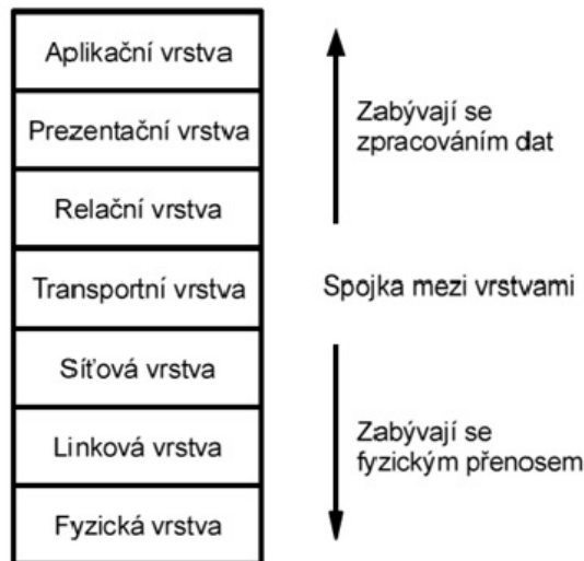
Obr. 6.2: Referenční model ISO/OSI [15]
