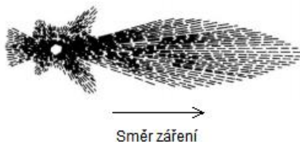
Obr. 3.8: Rozptyl záření na velkých částicích [9]
