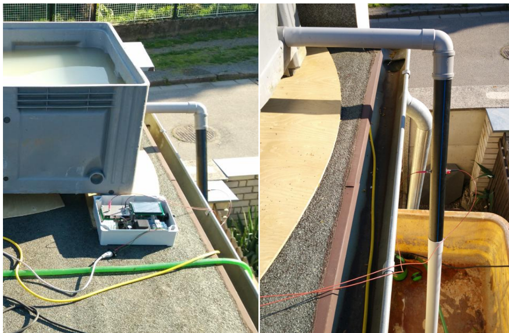
Obr. 9.8 a 9.9: Měřicí systém pro testování vlivu protékajícího roztoku na měřenou úroveň zakalení
