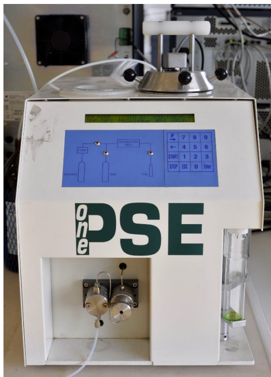
Obr. 8 Přístroj one PSE pro vysokotlakou extrakci (foto autorka)
