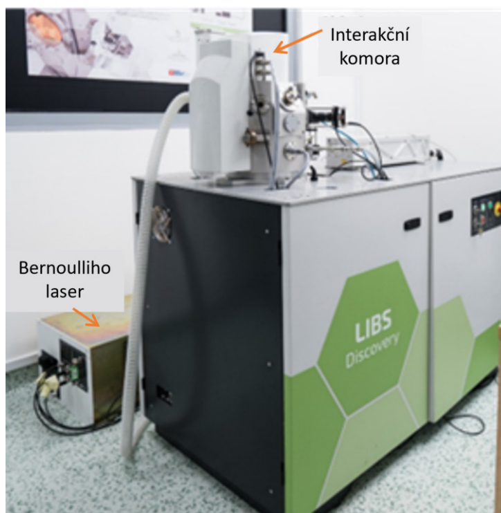
Obrázek 4.1: Fotografie experimentální sestavy LIBS Discovery.
