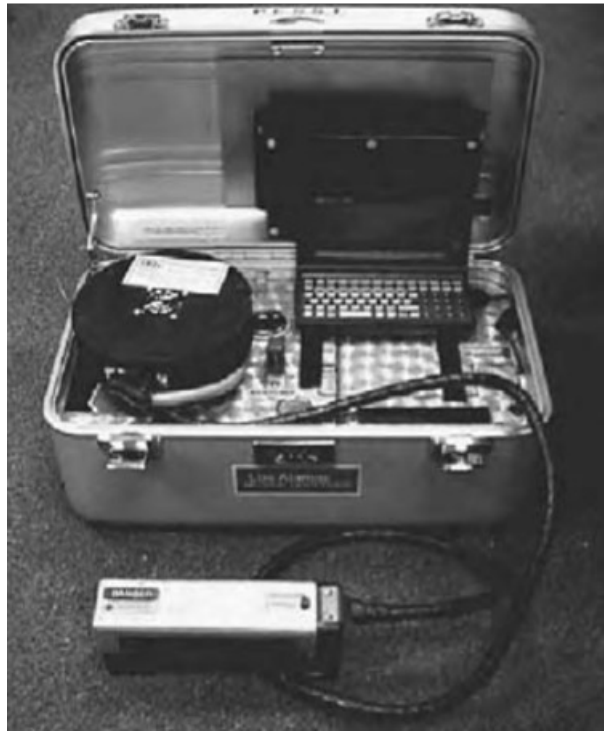
Obrázek 1.1: Přenosný aparát LIBS z roku 1988. Převzato z [2]
