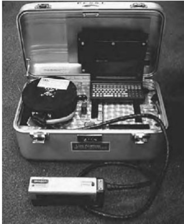
Obrázek 1.1: Přenosný aparát LIBS z roku 1988. Převzato z [2]
