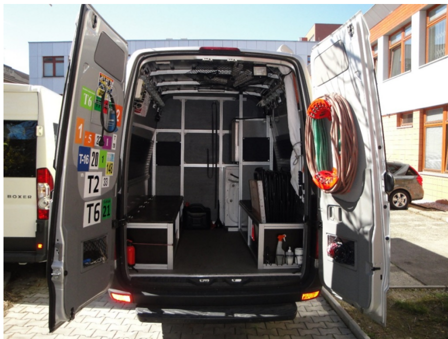
Obr. č. 5: Vozidlo VW Crafter se speciální vestavbou pro přepravu kol
