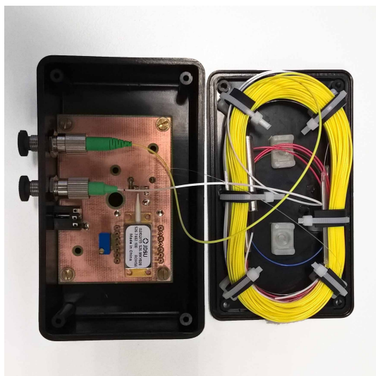
Obr. 4.9: Pohled na vnitřní uspořádání SFS zdroje
