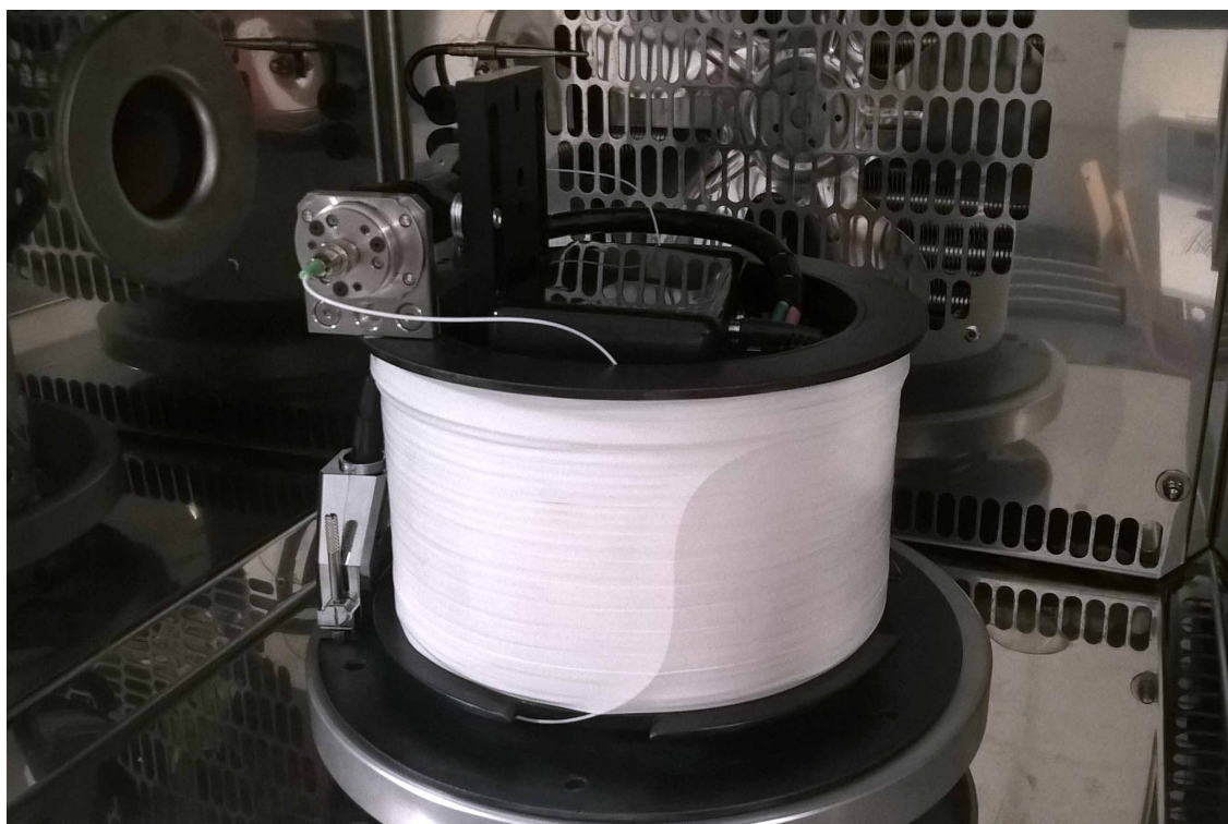
Obr. G.6: Sestavený I-FOG na rotačním stolku RMS uvnitř klimatické komory
