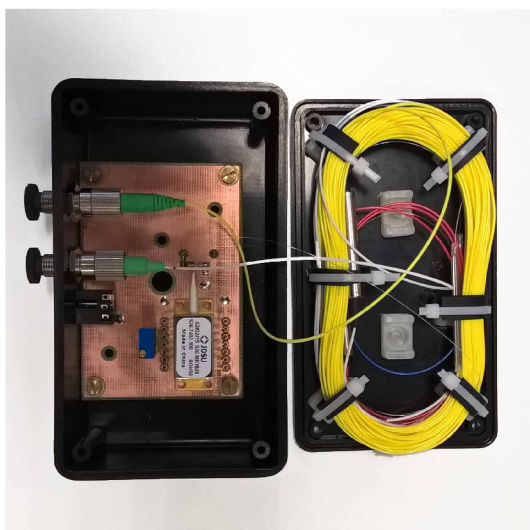
Obr. 4.9: Pohled na vnitřní uspořádání SFS zdroje
