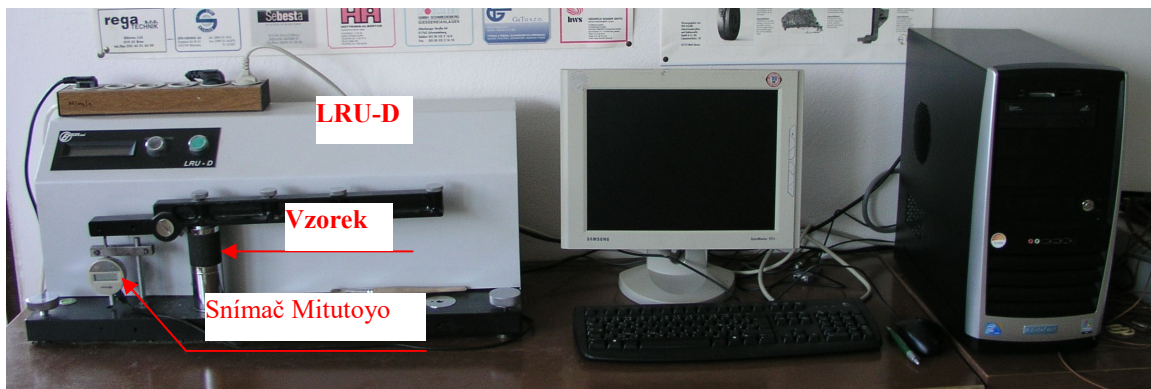
Obr. 42 Pevnostní přístroj LRU-D řízený PC
