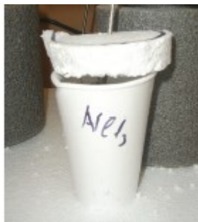
Obr. 10 Reakční nádobka o objemu 250 ml z pěnového polystyrenu o hmotnosti pod 2 g
