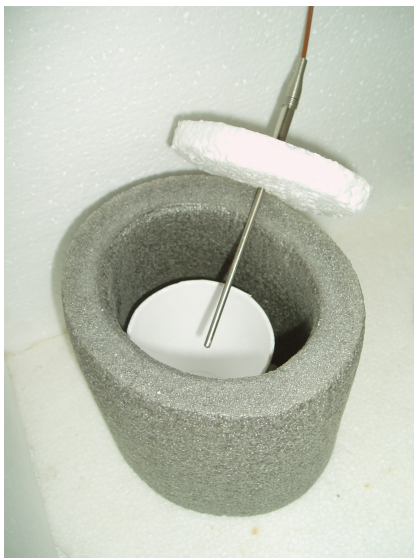
Obr. 11 Izolační komůrka pro uložení kelímku, termočlánek typu T
