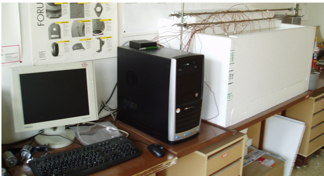
Obr. 13 Isoperibolický kalorimetr řízený PC
