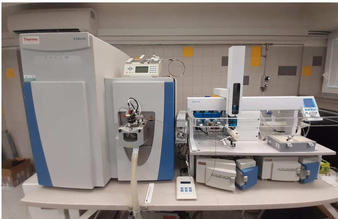
Obrázek 23: Kapalinový chromatograf s vysokorozlišujícím hmotnostním detektorem Q-Exacte (foto Kateřina Grabicová)
