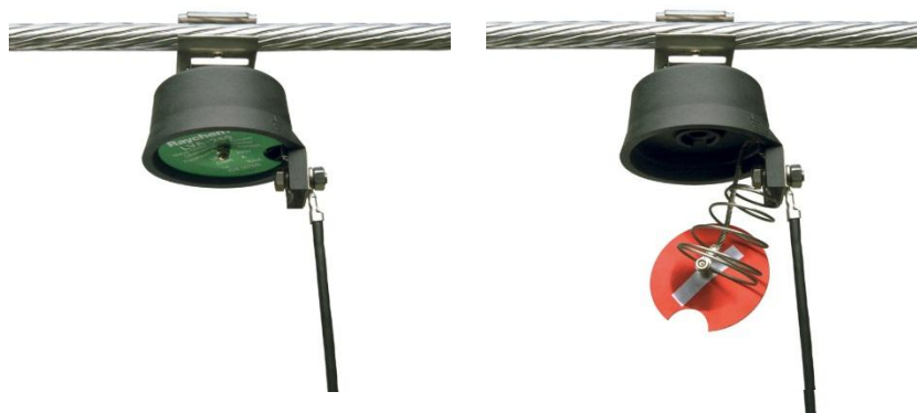
Obr. 20 Svodič přepětí na venkovní síti (odpojený omezovač při poruše)[24]
