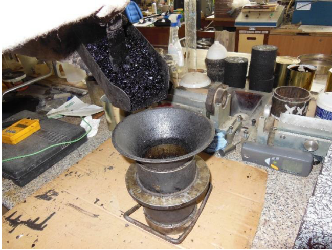
Obrázek 5- 24: Plnění nahřáté formy směsí SMA 11 S, [Vlastní zpracování]
