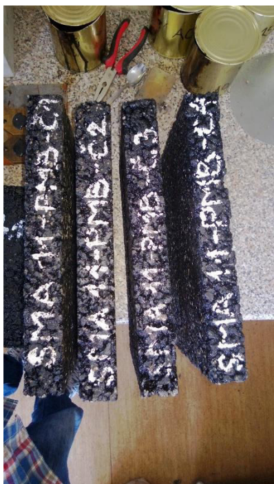
Obrázek 7- 47: Hotové zhutněné desky (pohled z boku), [Vlastní zpracování]
