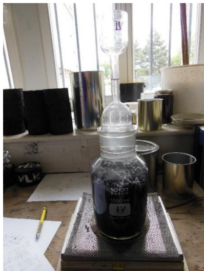
Obrázek 5- 29: Vážení pyknometru se směsí a doplněnou vodou po rysku, [Vlastní zpracování]
