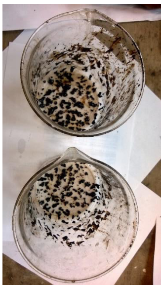
Obrázek 5- 39: Stékavost pojiva zkoušky 2- (pohled z vrchu), [Vlastní zpracování]
