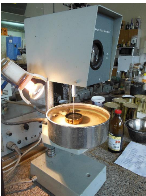
Obrázek 3- 11: Provádění penetrace pomocí penetrometru, [Vlastní zpracování]
