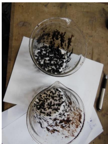
Obrázek 5- 37: Stékavost pojiva zkoušky 1- (pohled z vrchu), [Vlastní zpracování]
