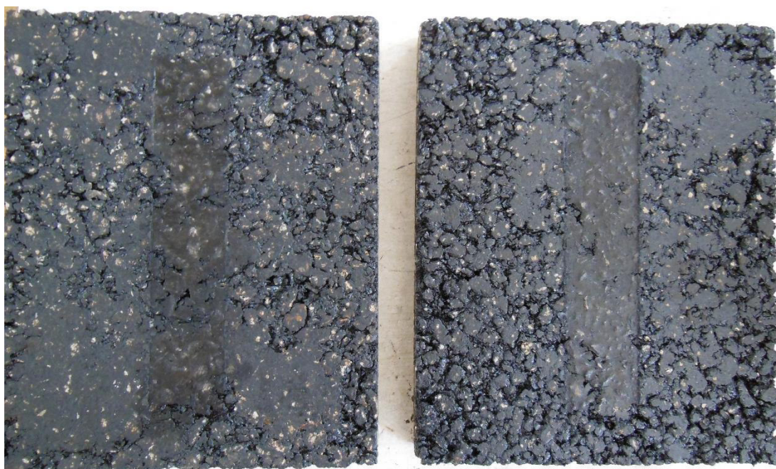
Obrázek 8- 52: Vizuální rozdíl hloubky vyjeté koleje desky 1 (levá) a desky 3 (pravá), [Vlastní zpracování]
