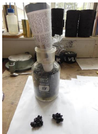
Obrázek 5- 27: Plnění pyknometru vychladlou směsí, [Vlastní zpracování]
