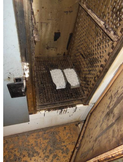
Obrázek 5- 34: Navážené vzorky kameniva se suší na teplotu míchání 165°C, [Vlastní zpracování]
