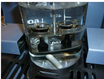
Obrázek 3- 15: Propad kuliček obalených asfaltem skrze kroužky na úroveň paprskových snímačů při 2. měření, [Vlastní zpracování]
