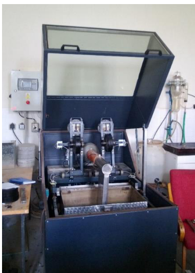
Obrázek 8- 51: Zařízení pro vyjíždění kolem, [Vlastní zpracování]
