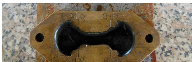
Obrázek 3- 17: Naplněná forma asfaltovým pojivem, [Vlastní zpracování]
