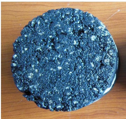
Obrázek 6- 40: Marshallovo těleso návrhu č.1, [Vlastní zpracování]
