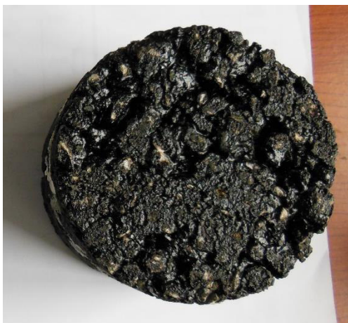
Obrázek 6- 42: Marshallovo těleso návrhu č. 3, [Vlastní zpracování]
