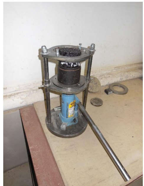
Obrázek 5- 21: Vytlačení zhuťného tělesa z formy, [Vlastní zpracování]
