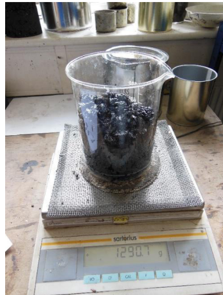
Obrázek 5- 33: Zvážení horké směsi po míchání, [Vlastní zpracování]
