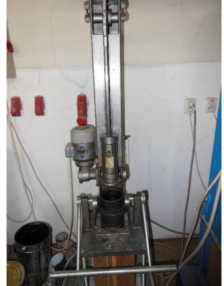
Obrázek 5- 23: Hutnění směsí rázovým zhuťovačem, [Vlastní zpracování]
