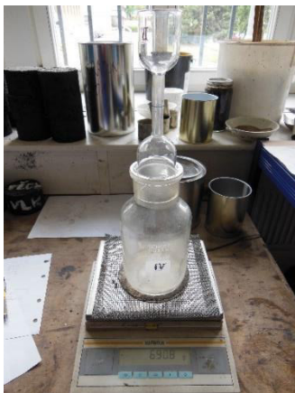
Obrázek 5- 28: Vážení samotného pyknometru, [Vlastní zpracování]
