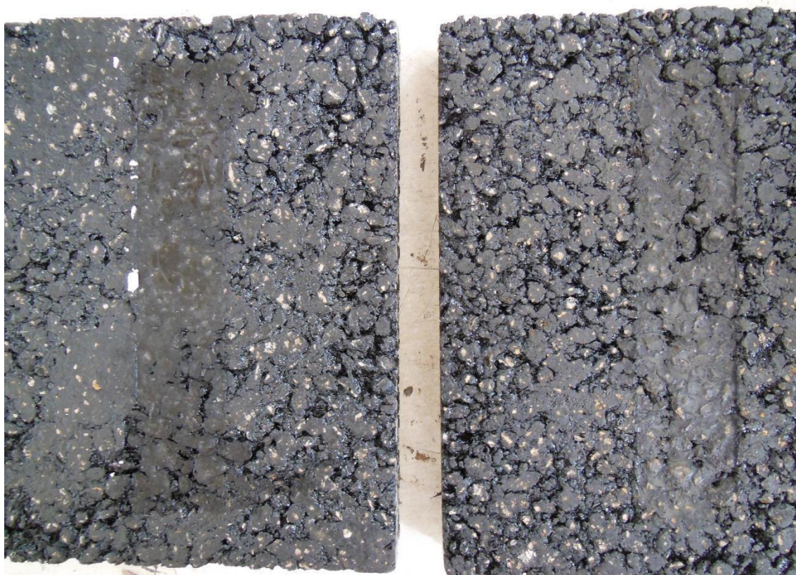
Obrázek 8 - 53: Vizuální rozdíl hloubky vyjeté koleje desky 2 (levá) a desky 4 (pravá), [Vlastní zpracování]
