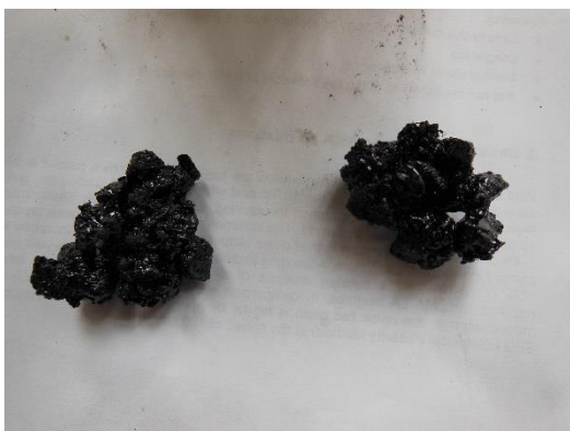
Obrázek 6- 43: Shluky kameniva spojené mastixem, [Vlastní zpracování]
