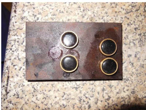
Obrázek 3- 14: Kroužky s odlitým asfaltovým pojivem PmB 45/80-65, [Vlastní zpracování]
