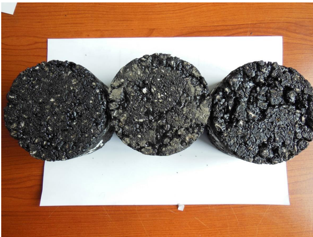
Obrázek 6- 44: Vizuální porovnání všech tří návrhů (zleva návrh č. 1, střed návrh č. 2. zprava návrh č. 3), [Vlastní zpracování]
