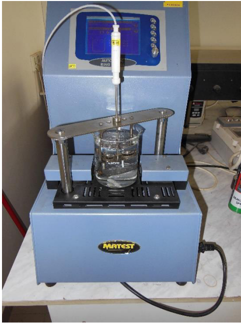
Obrázek 3- 12: Automatický přístroj Matest pro zkoušku kroužek- kulička, [Vlastní zpracování]
