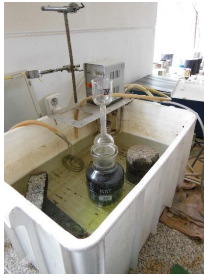
Obrázek 5- 30: Temperace pyknometru se směsí, [Vlastní zpracování]
