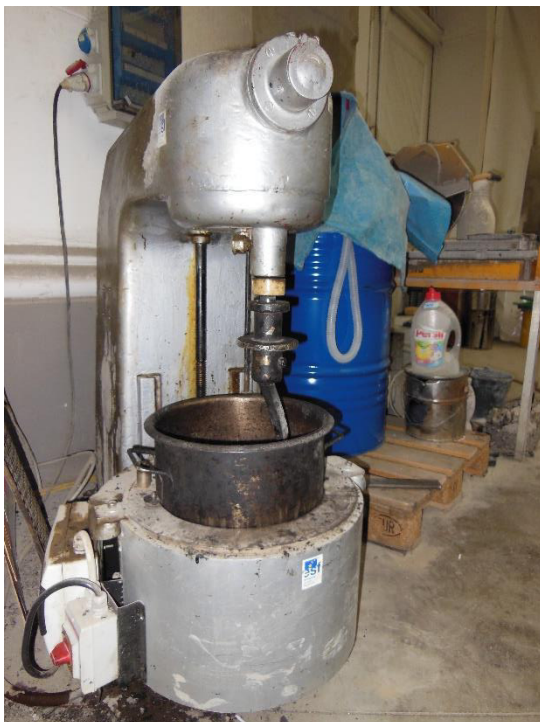
Obrázek 5- 20: Laboratorní míchačka s ohřevem, [Vlastní zpracování]
