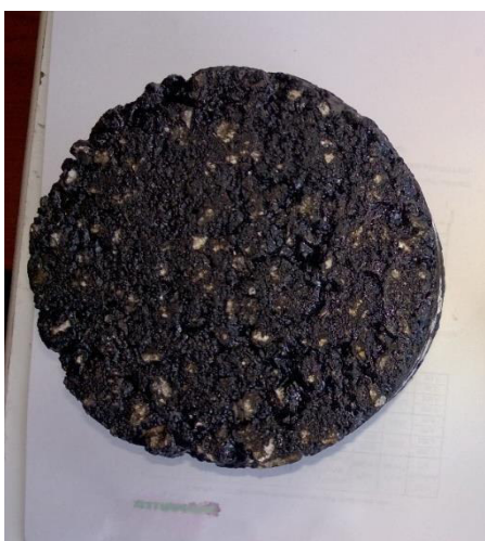
Obrázek 6- 41: Marshallovo těleso návrhu č.2, [Vlastní zpracování]
