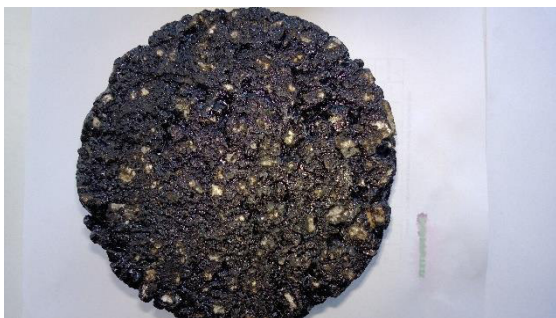
Obrázek 5- 25: Hotové Marshallovo těleso- pohled z vrchu, [Vlastní zpracování]
