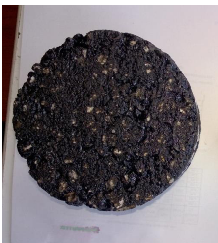
Obrázek 6- 41: Marshallovo těleso návrhu č.2, [Vlastní zpracování]
