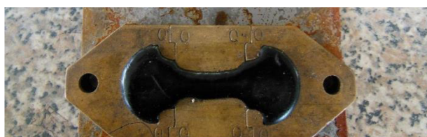
Obrázek 3- 17: Naplněná forma asfaltovým pojivem, [Vlastní zpracování]
