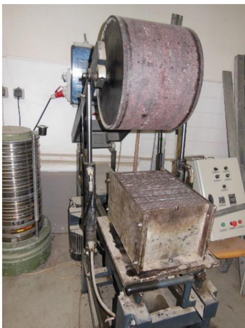
Obrázek 7- 45: Lamelový zhutňovač, [Vlastní zpracování]
