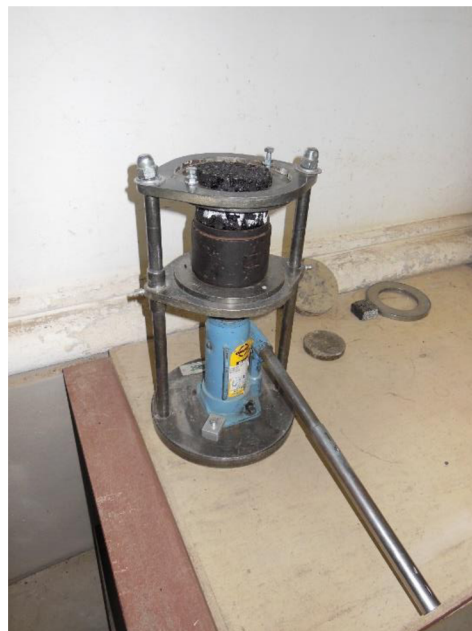
Obrázek 5- 21: Vytlačení zhutněného tělesa z formy, [Vlastní zpracování]
