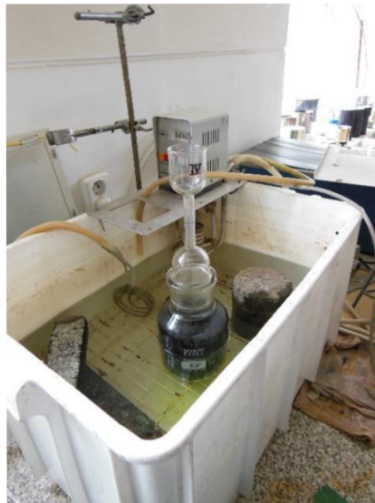
Obrázek 5- 30: Teplota pyknometru se směsí, [Vlastní zpracování]
