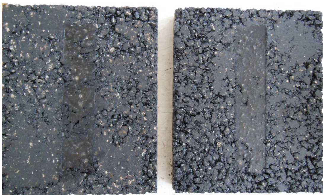
Obrázek 8- 52: Vizuelní rozdíl hloubky vyjeté koleje desky 1 (levá) a desky 3 (pravá), [Vlastní zpracování]
