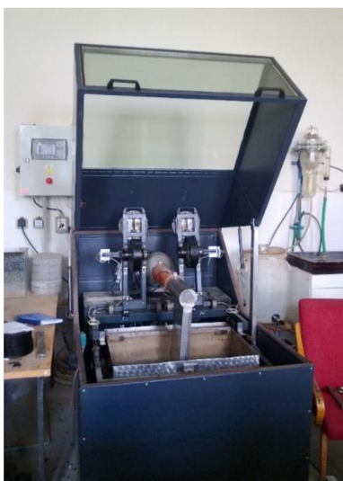
Obrázek 8- 51: Zařízení pro vyjíždění kolem, [Vlastní zpracování]
