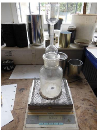
Obrázek 5- 28: Vážení samotného pyknometru, [Vlastní zpracování]
