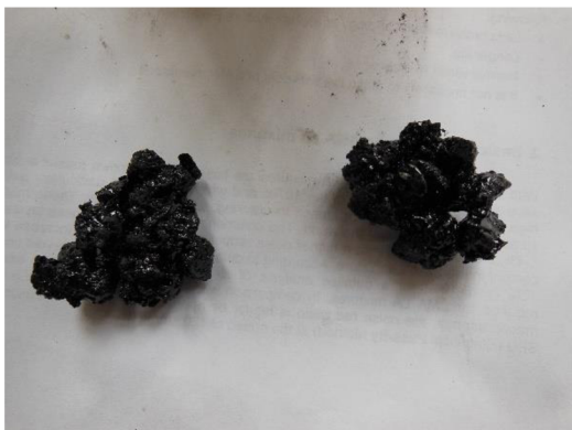
Obrázek 6- 43: Shluky kameniva spojené mastixem, [Vlastní zpracování]
