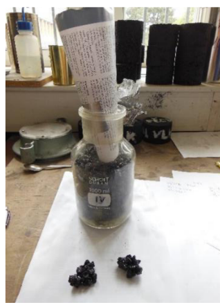
Obrázek 5- 27: Plnění pyknometru vychladlou směsí, [Vlastní zpracování]
