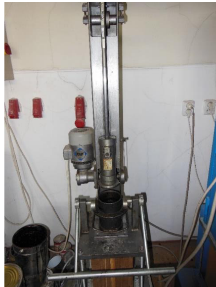
Obrázek 5- 23: Hutnění směsi rázovým zhutňovačem, [Vlastní zpracování]
