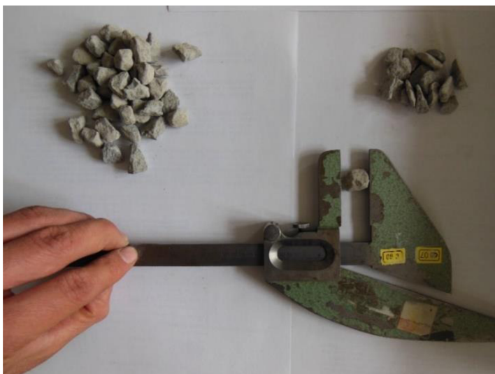
Obrázek 3 - 8: Roztřídění kubických a nekubických zrn pomocí dvoučelist'ového posuvného měřítka, [Vlastní zpracování]
