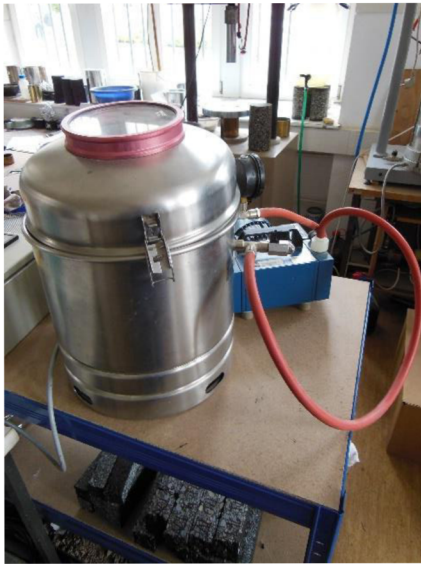
Obrázek 5- 31: Vytěsnění vzduchu z pyknometru v nádobě s vývěvou, [Vlastní zpracování]
