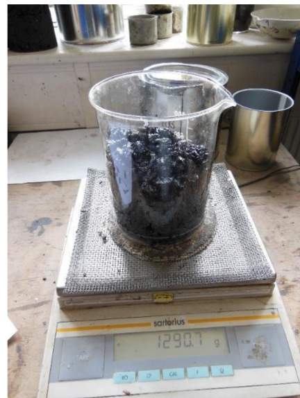
Obrázek 5- 33: Zvážení horké směsi po míchání, [Vlastní zpracování]
