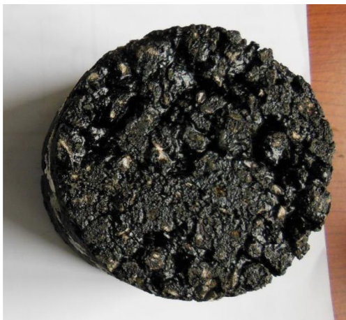
Obrázek 6- 42: Marshallovo těleso návrhu č. 3, [Vlastní zpracování]
