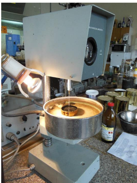
Obrázek 3- 11: Provádění penetrace pomocí penetrometru, [Vlastní zpracování]
