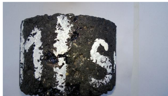
Obrázek 5- 26: Hotové Marshallovo těleso- pohled z boku, [Vlastní zpracování]
