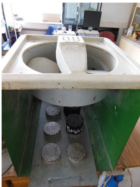
Obrázek 5- 22: Chlazení zhutněných vzorků pod ventilátorem, [Vlastní zpracování]
