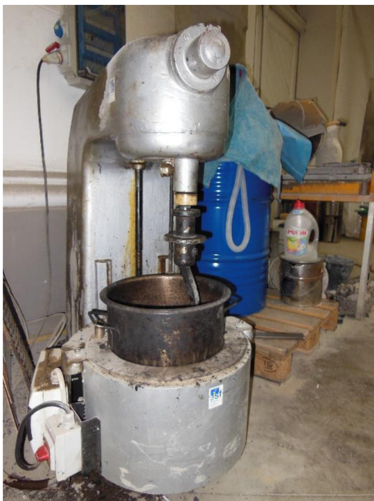
Obrázek 5- 20: Laboratorní míchačka s ohřevem, [Vlastní zpracování]
